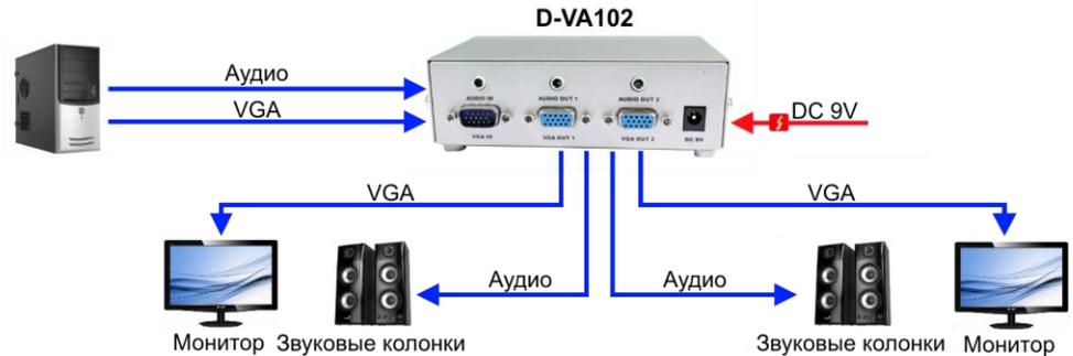
Рис.2 Структурная схема подключения D-VA102
